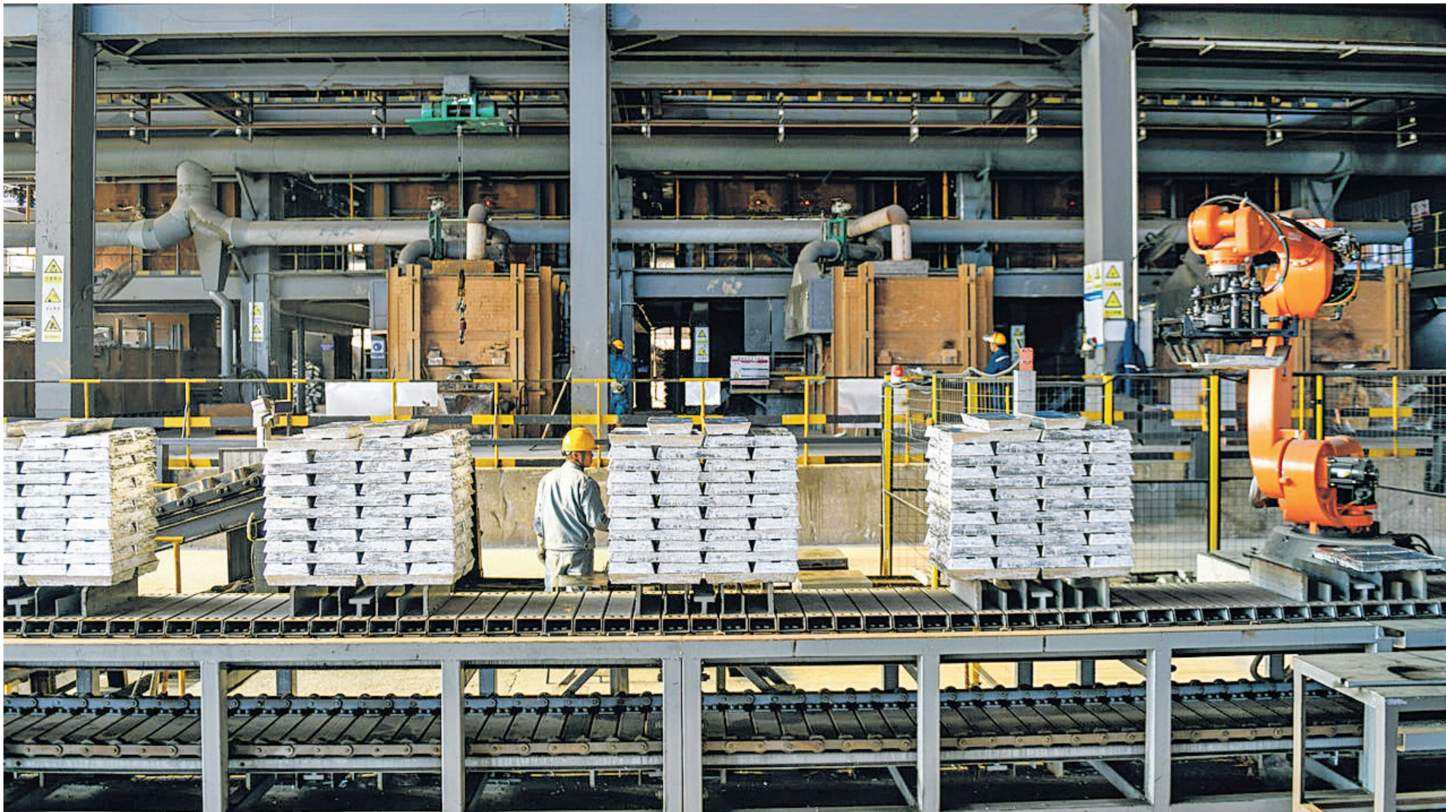
在黔西南州安龙县龙广镇的贵州西南能矿锌业有限公司内,机械臂正在码放刚下线的锌锭。刘朝富/摄
