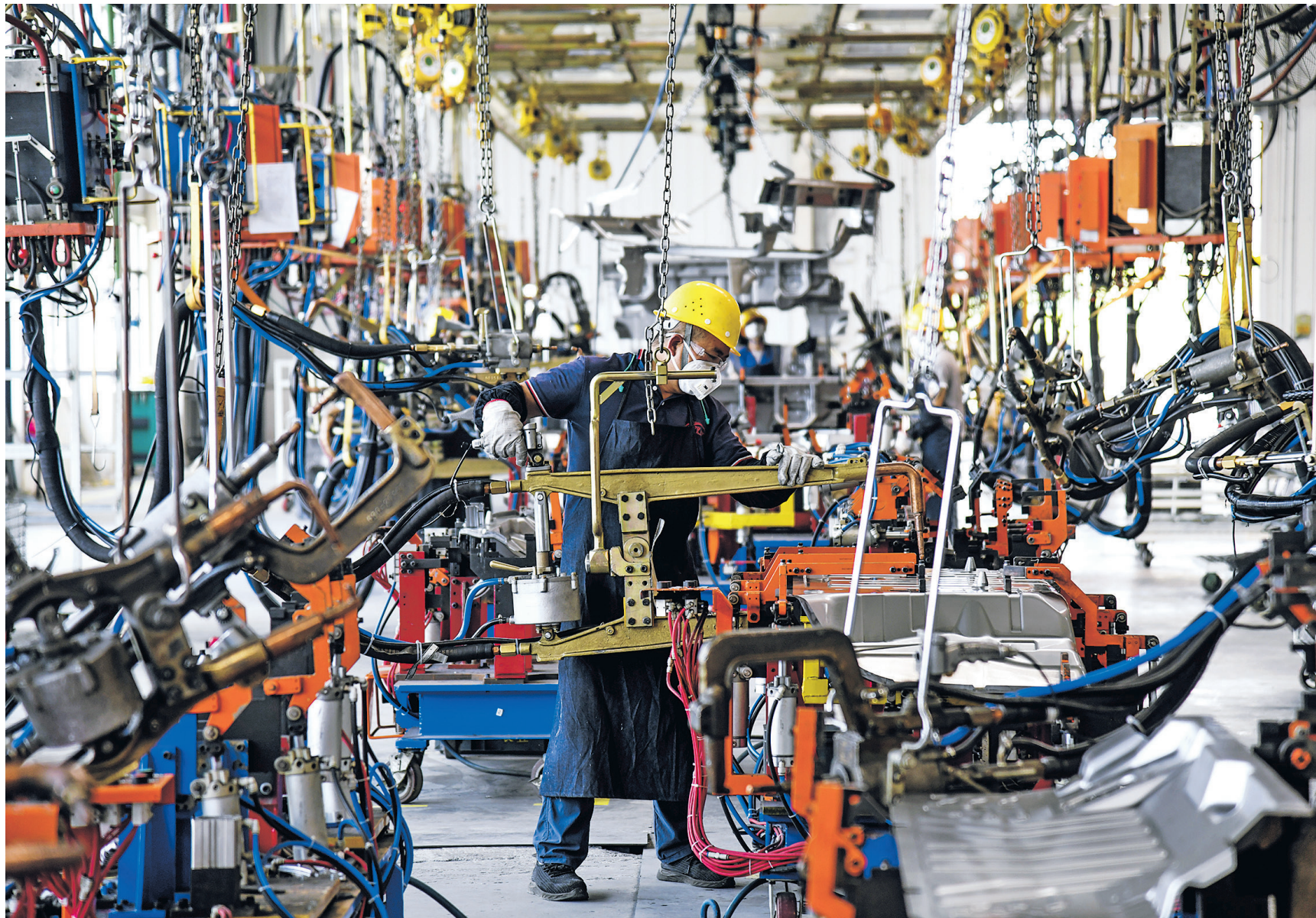
位于贵安新区贵州长江汽车有限公司焊装车间内,工人正为“贵州牌”电动卡车进行零部件焊装作业。杨涛/摄
